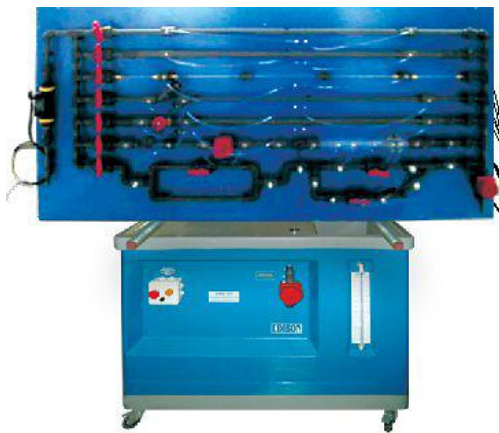
Lb6. Panel de fricción: pérdidas de carga
